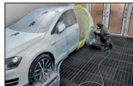
Auftragen des Lackes in der Lackieranlage
